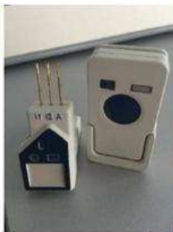
L'ERL : un module radio et son module d'appairage
